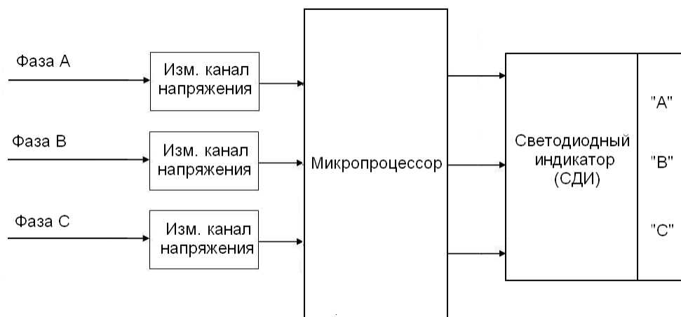
Рис. 6.2 – Структурная схема фазоуказателя
